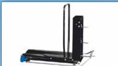
Questo sollevatore facilita il serraggio delle ruote di autocarri pesanti e offre ampio spazio per riporre coni, stelle di centraggio e ghiera di serraggio.
